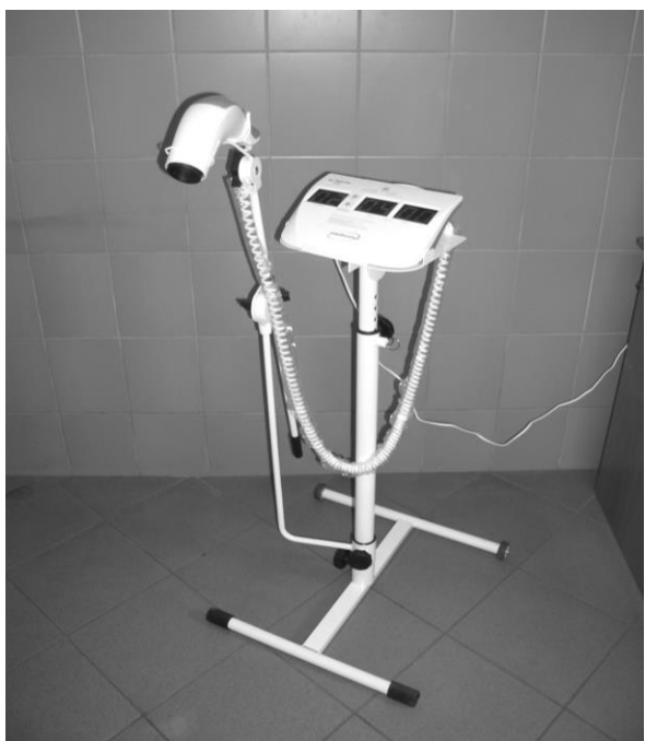
Ryc. 2. Lampa do terapii światłem spolaryzowanym Solaris (Medicolux, Polska). Fig. 2. Lamp for polarized light therapy Solaris (Medicolux, Poland).
