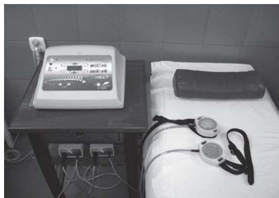
Rycina 6. Zestaw do magnetoledoterapii Viofor JPS Standard z aplikatorami magnetyczno-światelnymi (Med&Life, Poland)
